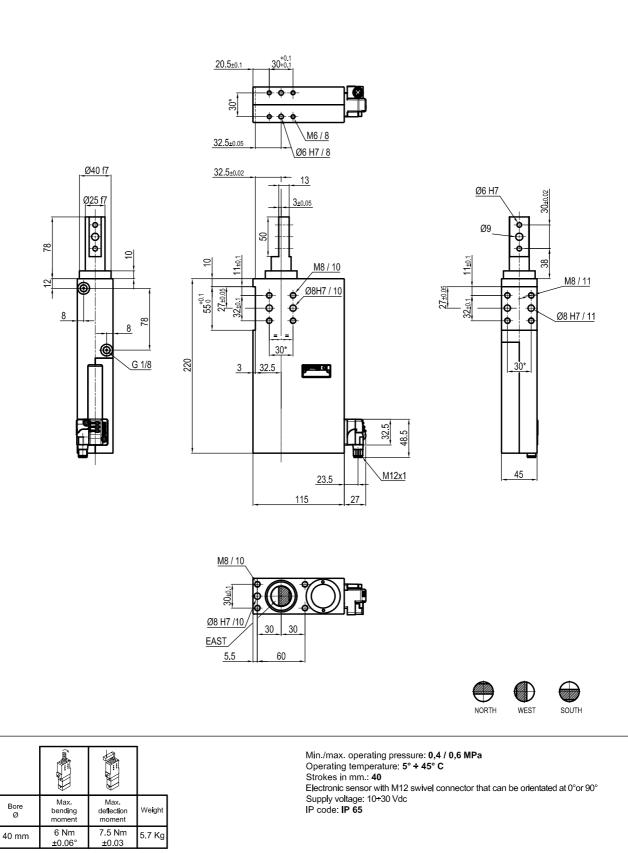
\* : TOLERANCE BETWEEN DOWEL HOLES ± 0.02, TO SCREW HOLES ± 0.1
